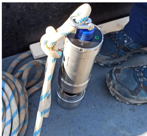
Figura 6 Montaje del SVP en la embarcación para realizar el perfil de velocidades.
