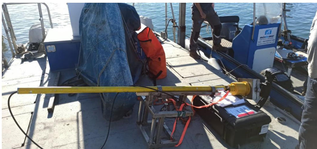
Figura 4 Montaje de la cabeza de la ecosonda multihaz e IMU.
