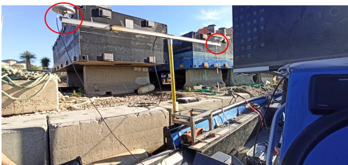
Figura 8 Localización de las antenas GNSS en el montaje.
