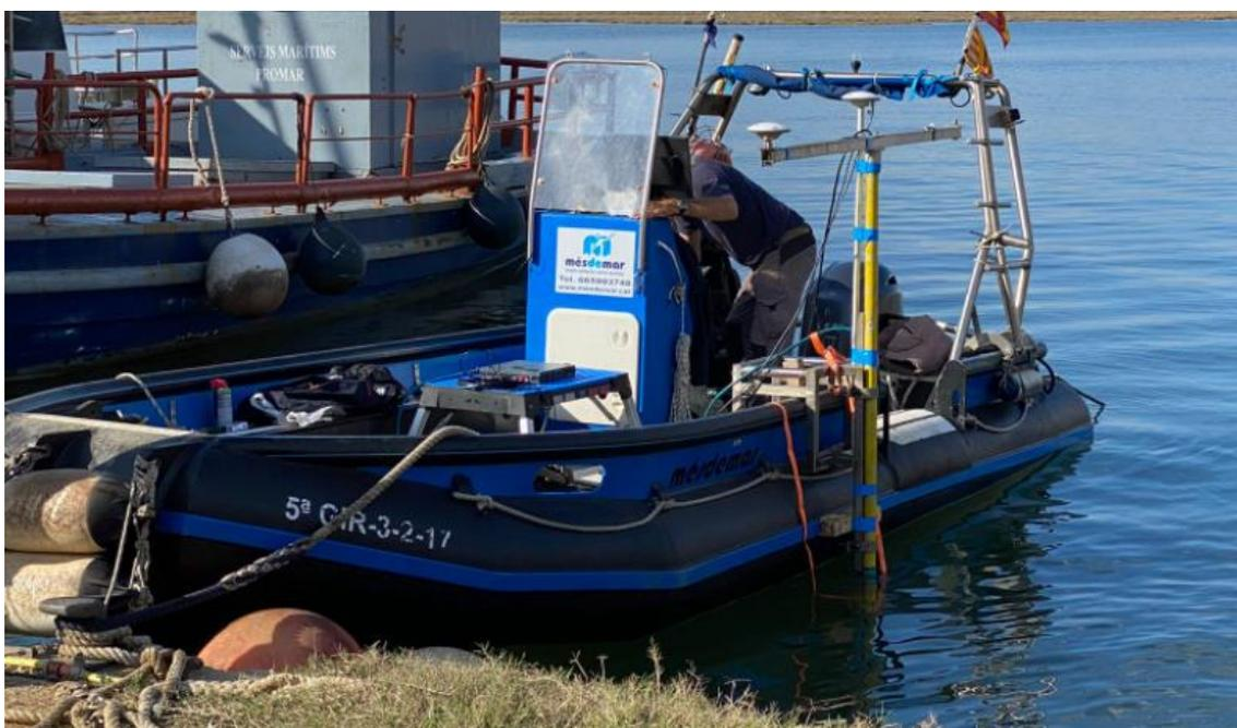
Figura 5 Montaje de la MBES en la embarcación.
