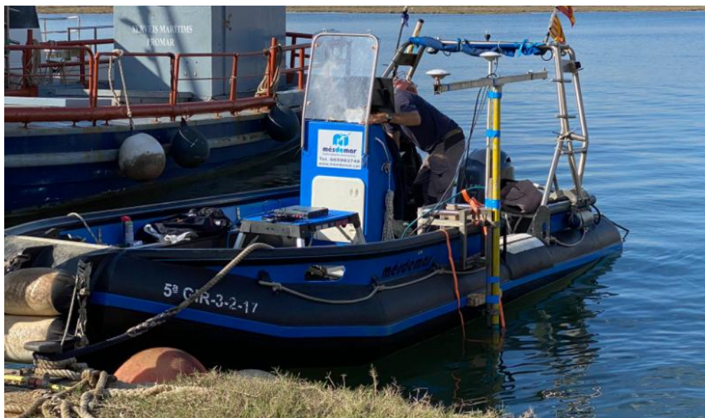
Figura 5 Montaje de la MBES en la embarcación.
